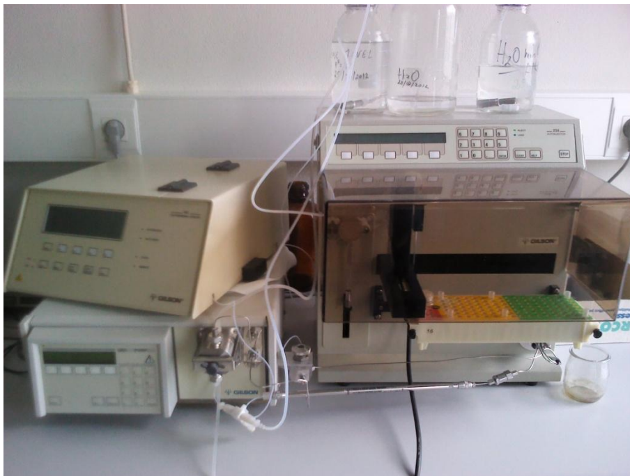
Figura 15 - Sistema de HPLC utilizado neste estudo para quantificação de monoaminas (Fotografia tirada no Laboratório de Farmacologia e Terapêutica Experimental da Faculdade de Medicina da Universidade de Coimbra).
