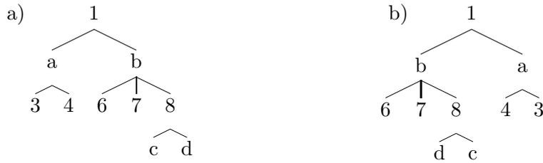
Figura 2.3: a) Árvore  $t_1$  b) `botUpMapMRData reverseSubData id t1`
