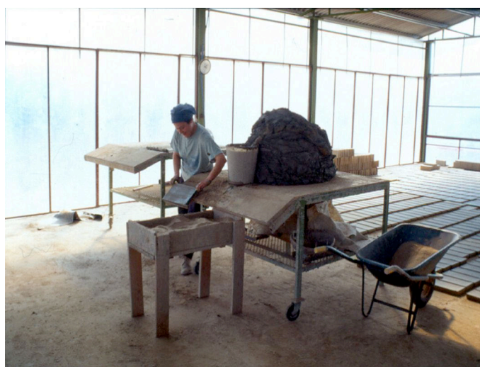
Figura 1. A moldagem e secagem artesanal de tijolos e ladrilhos de barro antes de serem cozidos em forno de lenha. Vetriolo (Viterbo), Itália. Fotografia do autor, 2006.
