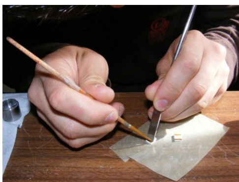
Figura 12- Criação da superfície de contacto da amostra.
