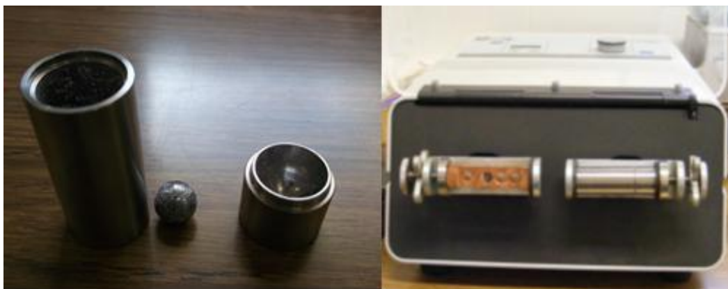
Figura 6 - À esquerda, elementos constituintes do recipiente metálico. À direita, máquina para homogeneizar os pós.
