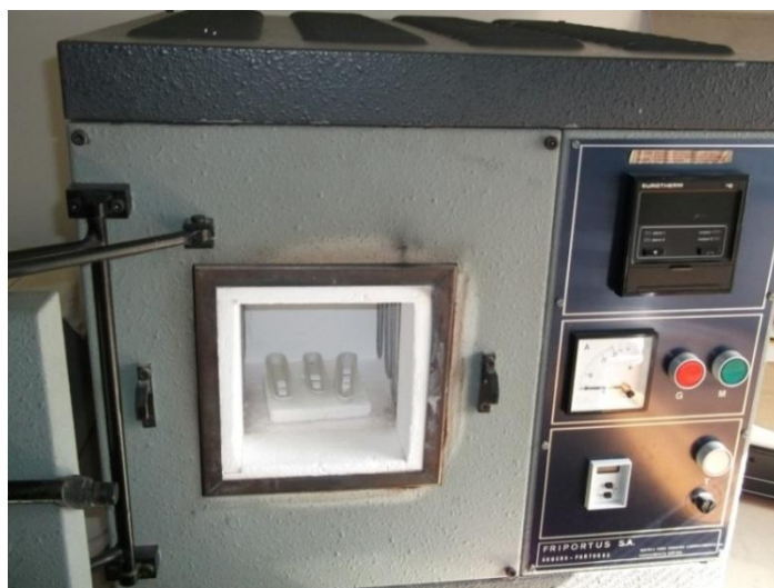
Figura 13- Forno utilizado para o processo da sinterização.
