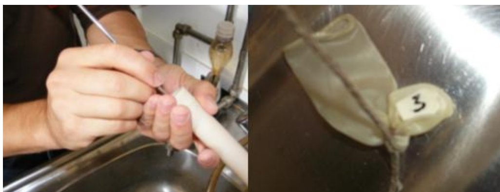
Figura 8 - À esquerda, colocação da amostra na dedeira. À direita, amostra isolada depois de ter criado vácuo.
