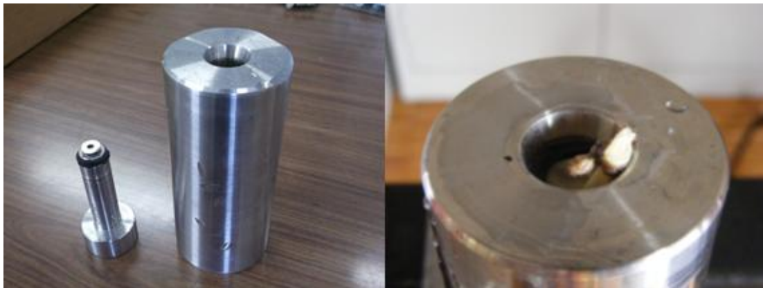
Figura 10 - À esquerda, elementos constituintes do molde. À direita, amostra mergulhada no líquido do molde.
