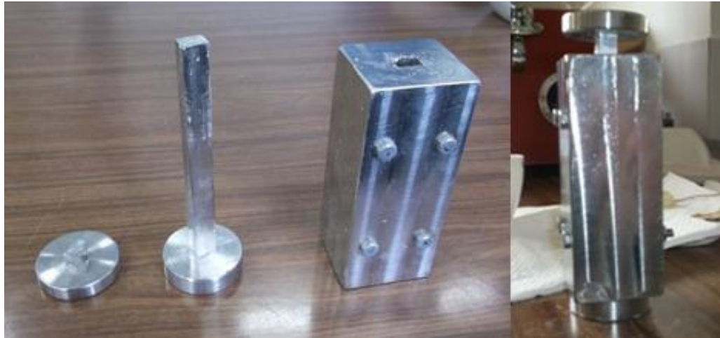
Figura 7- À esquerda, elementos constituintes do molde. À direita, molde a formar a amostra.
