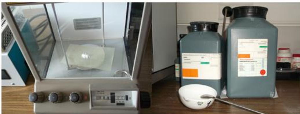
Figura 5- À esquerda, balança analítica de precisão, Mettler H54AR. À direita, reservatório dos pós e o almofariz.
