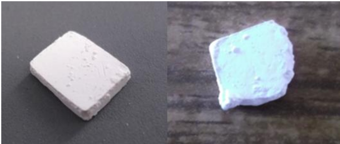
Figura 9- À esquerda, amostra após ser moldada. À direita, amostra degradada durante a sua fase de produção.
