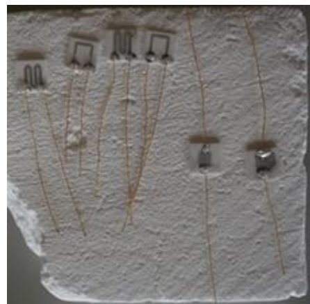
Figura 15 - a) - Fonte de tensão a alimentar a resistência de aquecimento do tipo M.. b) - Resistências de aquecimento depois de reparadas.
