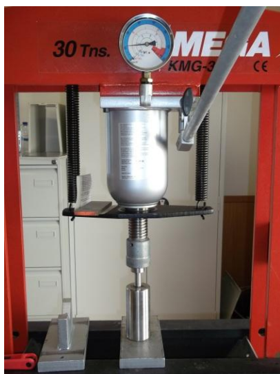
Figura 11- Prensa a pressurizar as amostras.
