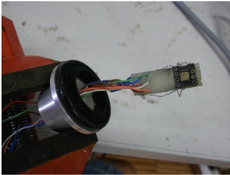
Figura 4- Suporte da amostra e da resistência de aquecimento, condutores que estabelecem o contacto entre o exterior e o interior da câmara de ensaios.
