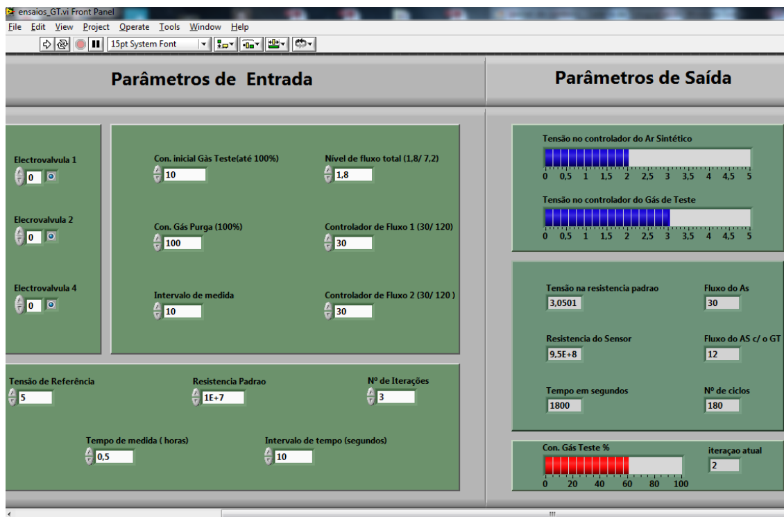
Figura 23- Painel Frontal do programa desenvolvido para controlo do sistema de ensaios e aquisição de dados.
