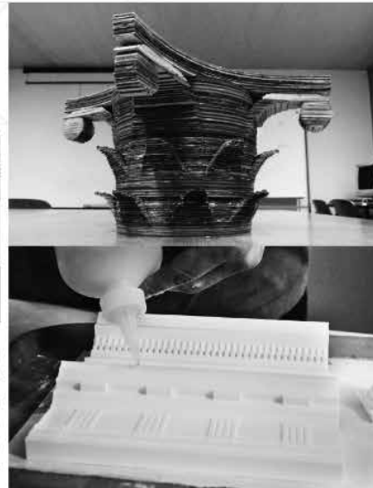
Figura 2. Estabulocum produzido com 3D printer e capital corviana obtida por conversão a laser.
