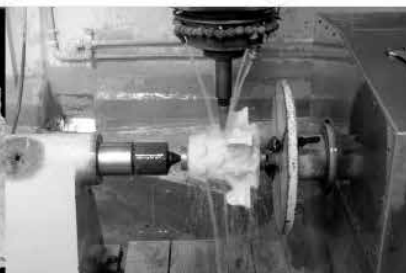
Figura 2. Equipamento de fresagem CNC.
