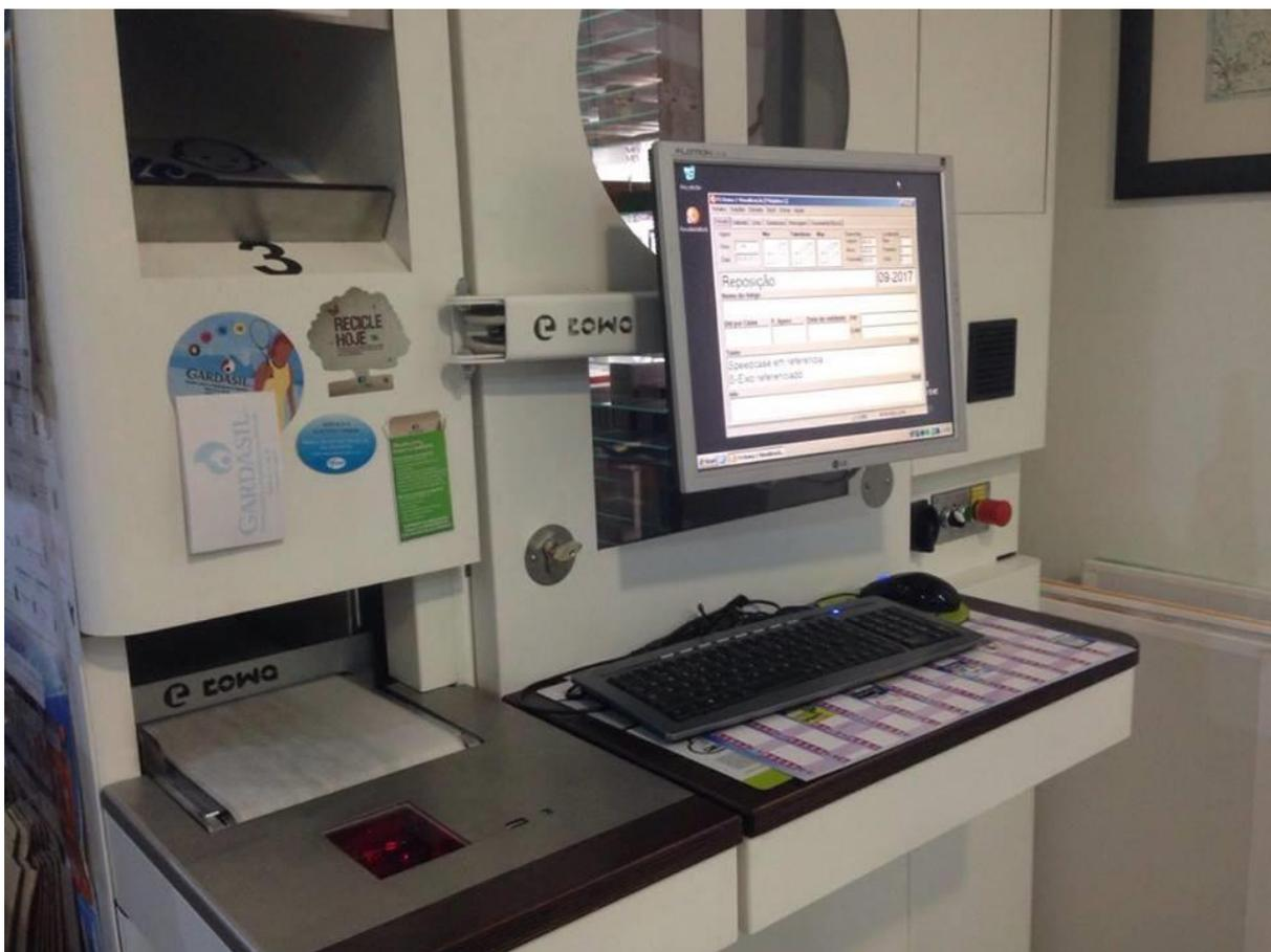
*Figura 6 - Parte externa do robot onde se dá a entrada dos medicamentos.*
