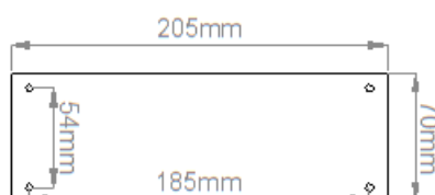
Figura A.2: Desenho e dimensões da união dos apoios do computador portátil.
