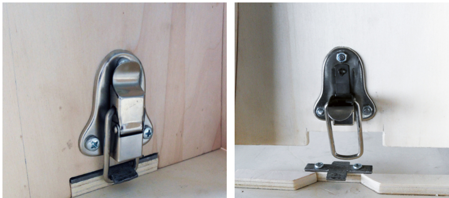
Figura 3.5: Fecho construído para fixar a coluna do robot.
