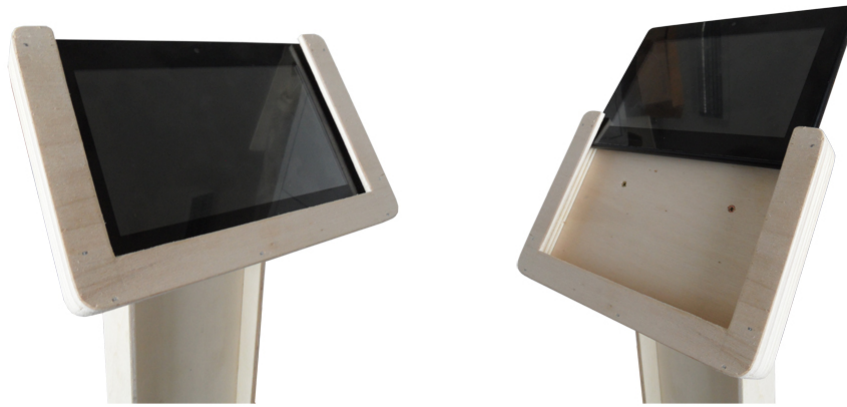
Figura 3.4: Suporte construído para apoiar o tablet.
