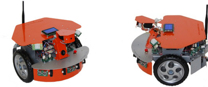
Figura 3.1: Robô utilizado, X80Pro - Dr Robot. Imagens retiradas de [7].
