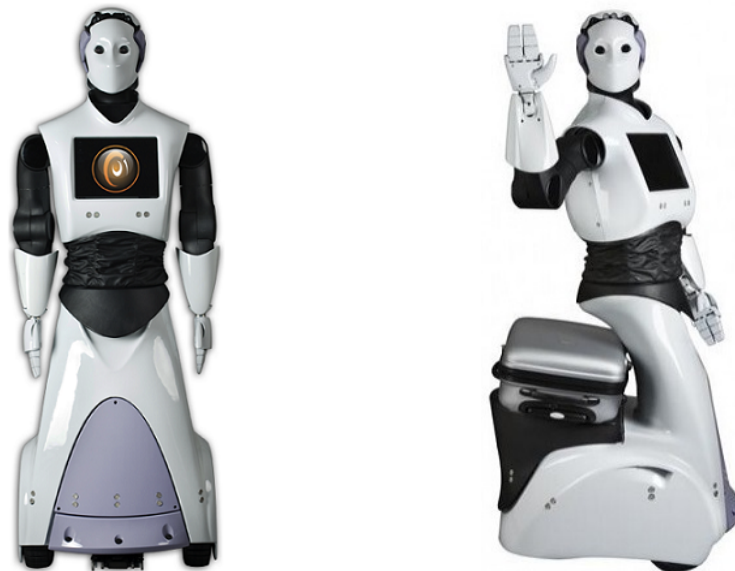
Figura 2.2: REEM, robô guia da PAL Robotics. Imagens retiradas de [6].
