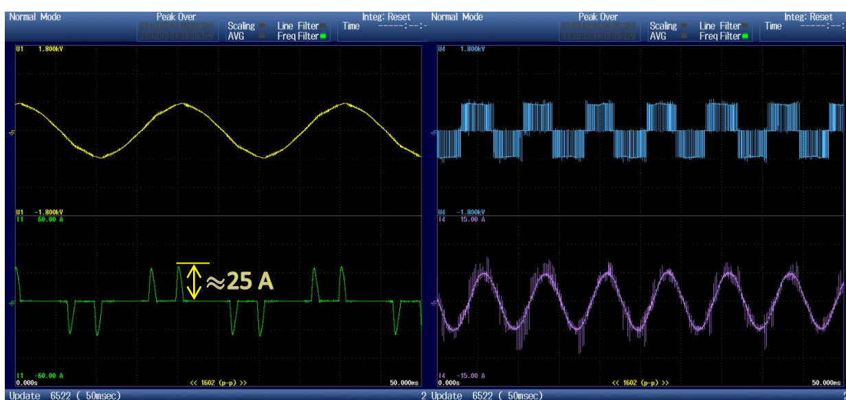
Figura 27: Formas de onda das tensões (em cima) e correntes (em baixo) à entrada do conversor de frequência (esquerda) e à entrada do motor (direita), registadas a 100% da velocidade e à plena carga (10,53 N.m).
