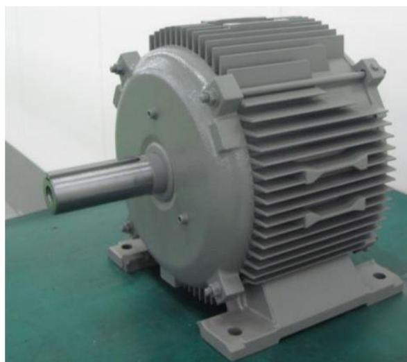
Figura 53: Fotografia do protótipo de 11kW da Hitachi. É claramente visível a redução do comprimento axial deste moto [28].
