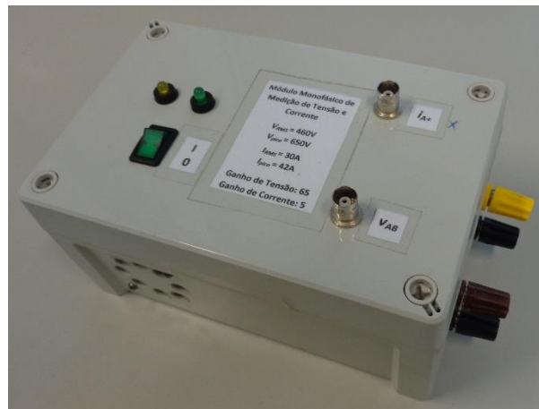
Figura B.18 – Sensor de tensão monofásico, utilizado para medição da tensão de um condensador.
