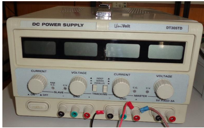
Figura B.17 – Fonte DC utilizada para alimentar uma das placas de acondicionamento de sinal.
