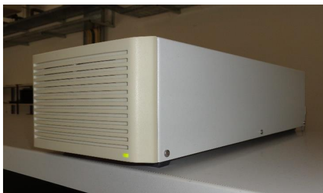
Figura B.15 – Módulo de processamento de dados DS1103 PPC Controller Board.
