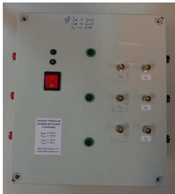
Figura B.19 – Sensor de tensão e corrente trifásico, utilizado para medir as tensões e correntes de saída do inversor.
