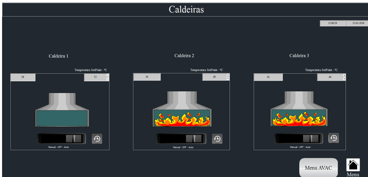
Figura 4. 5- Vista de funcionamento das Caldeiras
