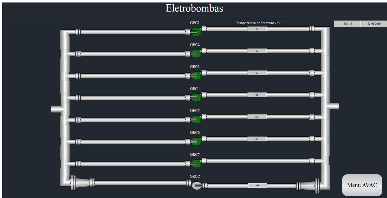
Figura 4. 6- Interface "Eletrobombas" e Temperatura de Imersão
