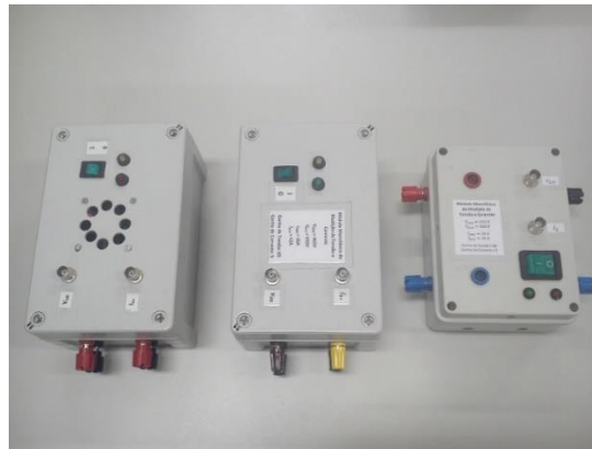
Figura C.10 - Módulos monofásicos de medição e tensão e corrente.
