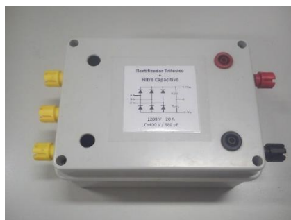
Figura C.2 - Retificador trifásico a díodos juntamente com o filtro capacitivo.
