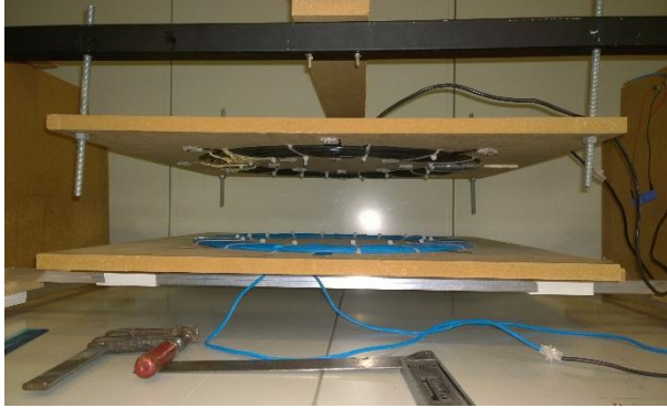
Figura C.6 : Enrolamento primário e secundário do transformador IPT.
