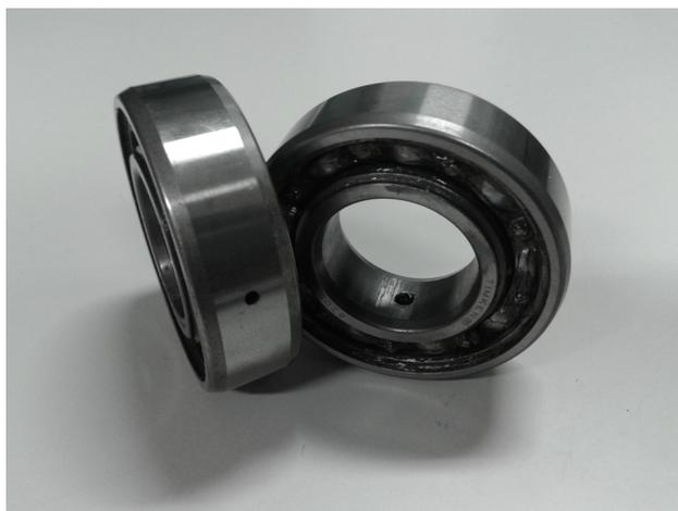
Figura 4.8: Rolamentos com furos únicos de 2 e 4 mm.
