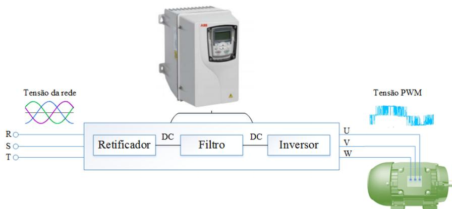
Figura 3.10: Esquema de montagem e princípio de funcionamento de um variador eletrônico de velocidade.
