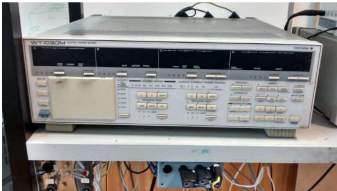
Fig. 45- Imagem do analisador de potência utilizado nos ensaios do rendimento e limite de velocidade/binário.
