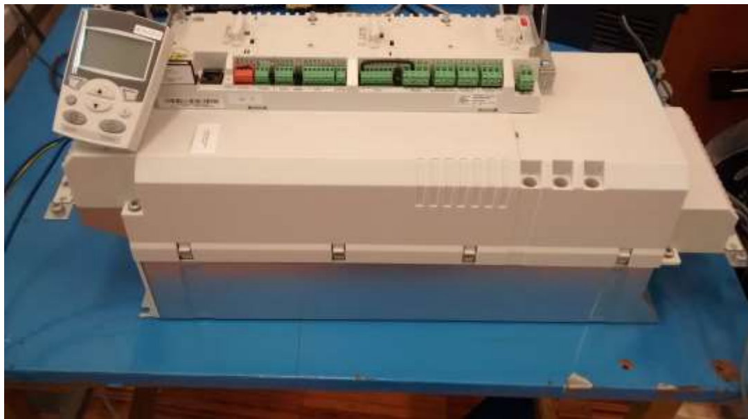
Fig. 48- Variador eletrônico de velocidade utilizado no paralelo com o motor de indução de 11 kW.
