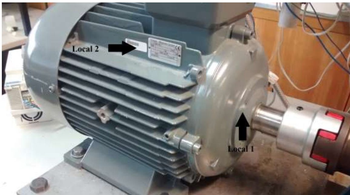
Fig. 17- Locais de medição da temperatura na carcaça.
