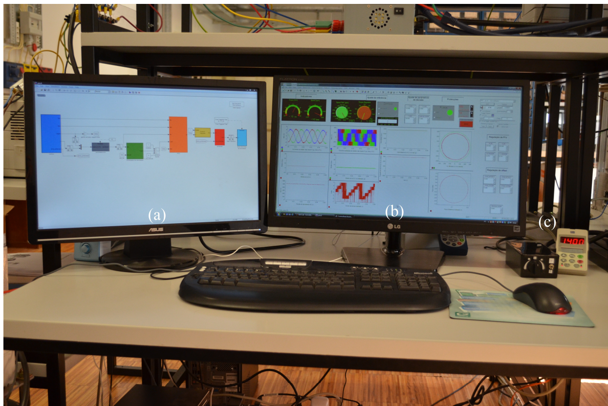
Fig. 48 - Painel de controlo: (a) Modelo do controlador; (b) Painel do ControlDesk; (c) Controladores remotos do VSD
