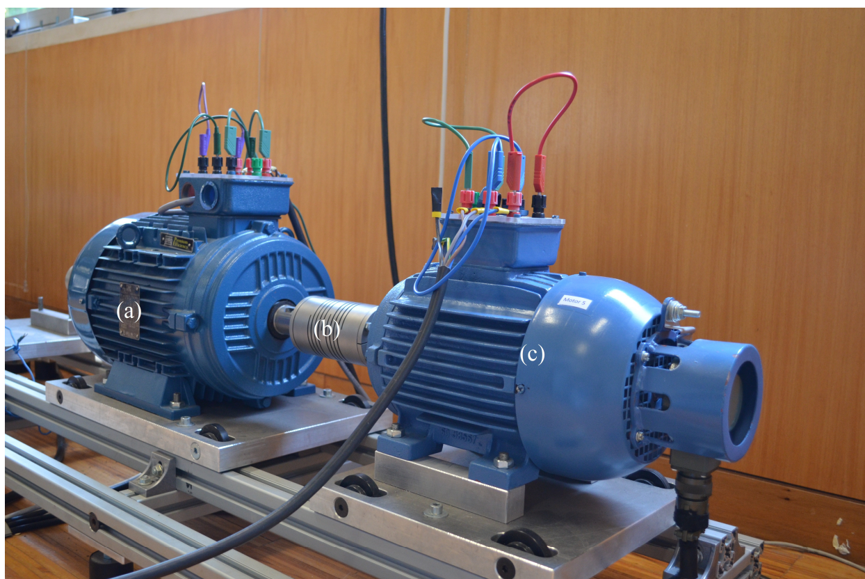
Fig. 43 - Montagem laboratorial dos motores de indução: (a) Carga mecânica controlada pelo VSD; (b) Acoplamento semiflexível; (c) Motor controlado através do PTC.
