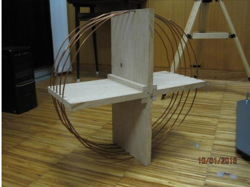
Figura 3.4 - Representação da antena fabricada
