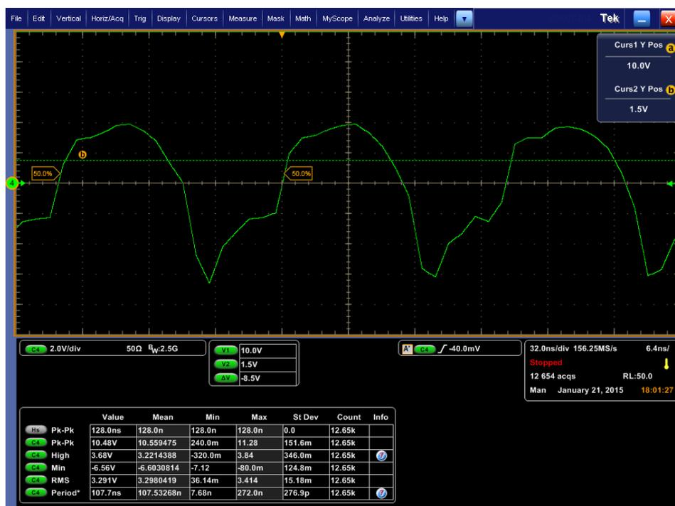
Figura 4.5 – Representação da onda de tensão aos terminais do LED quando as bobinas estão a 25 cm de distância uma da outra.
