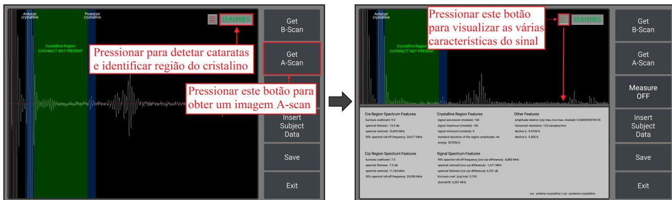
Figura 6.3: Demonstração para obtenção de uma imagem A-Scan
