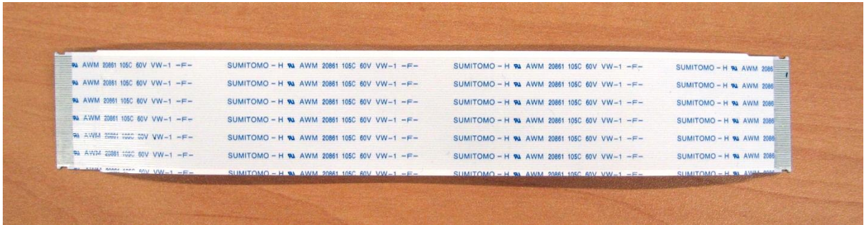
Figura 30 - Fita FFC utilizada na ligação
