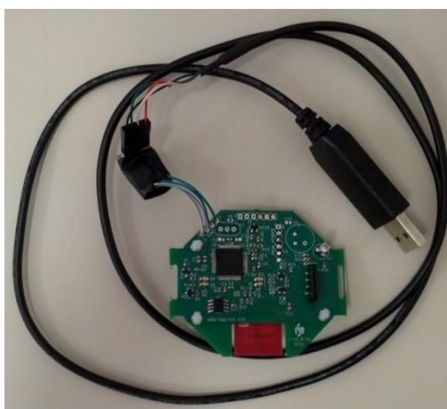
Figura 51 – Módulo de interface e controlo com ligação USB para PC.
