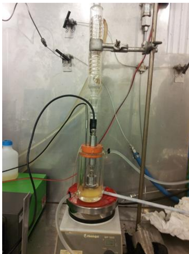
Figura 25 – Montagem utilizada para obtenção de leituras com o transdutor A102.
