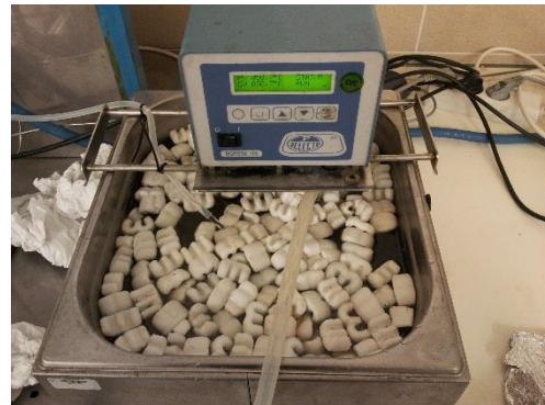
Figura 14 – Banho térmico com controlador.
