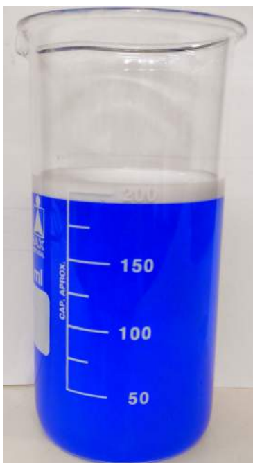
(a) Emulsão antes de ser colocado o estireno
