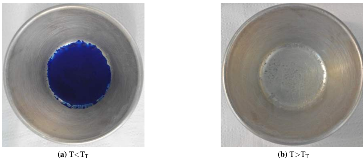
Figura 3.1: Imagens de TEMs nos dois estados de coloração, azuis a T < T_T (a) e transparentes a T > T_T (b).
