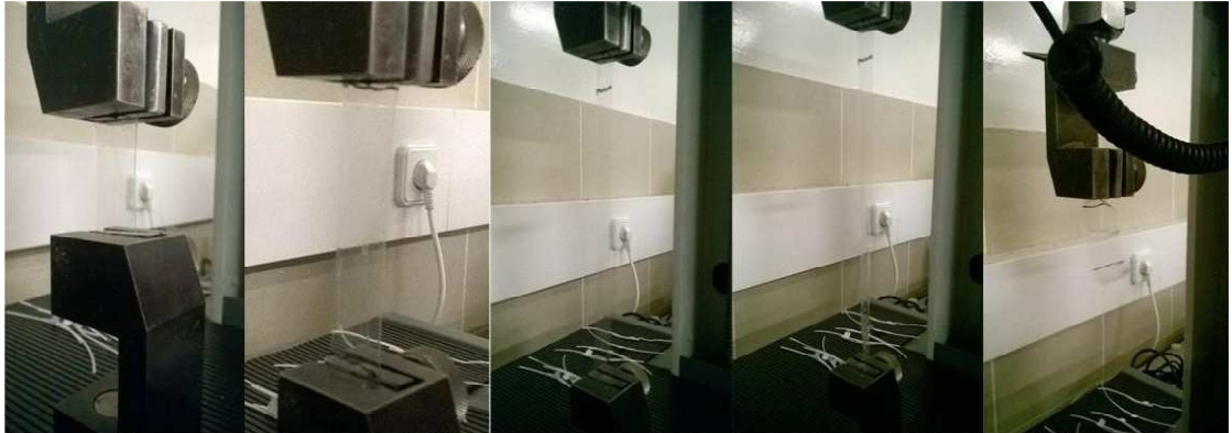
Figura 16: Sequência de fotografias tiradas durante um ensaio de tração ao material DLN-SD.
