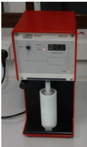
Figura 12 - Equipamento de medição de potencial utilizado.
