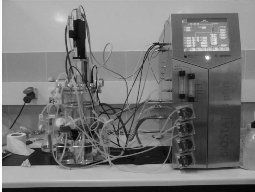
Figura 3.3 – Reator/fermentador de bancada BIOSTAT® Bplus (Sartorius).
