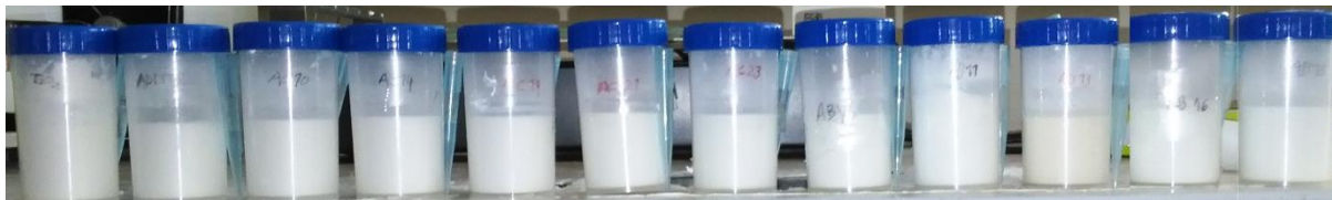
Figura E.1-Suspensões aquosa de \text{TiO}_2 com os copolímeros de bloco como dispersantes, amostras dos testes de viscosidade, no dia 0. Da esquerda para a direita : \text{TiO}_2 , Additol VXW 6200, PAA 51 - b -PDMAEMA 56 , PAA 80 - b -PDMAEMA 60 , PAA 38 - b -PDMEAMA 23 , PAA 24 - b -PDMAEMA 11 , PAA 23 - b -PDMAEMA 16 , PAA 80 - b -P4VP 76 , PAA 40 - b -P4VP 27 , PAA 67 - b -P4VP 21 ,PAA 86 - b -P4VP 59 , PAA 23 - b -P4VP 40 (dia 0).
