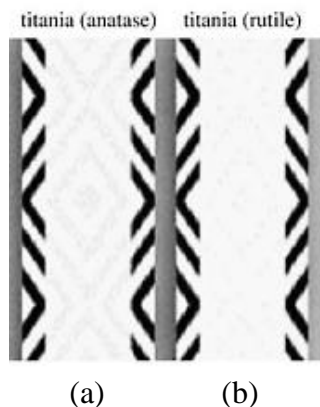
Figura 1 - Efeito do índice de refração dos pigmentos de anástase(a) e rutilo (b) na opacidade de um filme de tinta (Farrokhpay, 2009).
