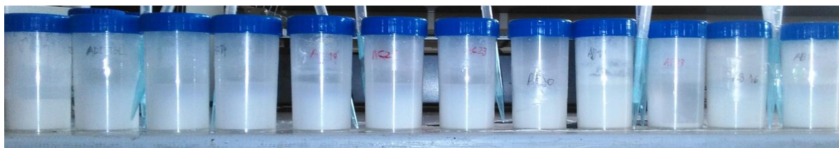
Figura E.3- Figura E.1-Suspensões aquosa de \text{TiO}_2 com os copolímeros de bloco como dispersantes, amostras dos testes de viscosidade, no dia 6 . Da esquerda para a direita : \text{TiO}_2 , Additol VXW 6200, PAA 51 - b -PDMAEMA 56 , PAA 80 - b -PDMAEMA 60 , PAA 38 - b -PDMEAMA 23 , PAA 24 - b -PDMAEMA 11 , PAA 23 - b -PDMAEMA 16 , PAA 80 - b -P4VP 76 , PAA 40 - b -P4VP 27 , PAA 67 - b -P4VP 21 ,PAA 86 - b -P4VP 59 , PAA 23 - b -P4VP 40 (dia 10).
