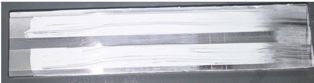
Figura F.1- Amostra Filme de tinta com copolímeros de bloco PAA 51 -b-PDMAEMA 56 .
