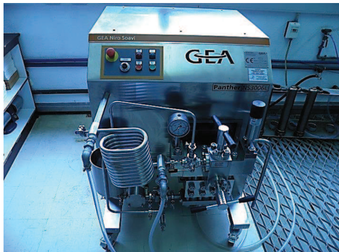
Figura 2.3 - Homogeneizador mecânico utilizado para produzir as nanoceluloses estudadas.
