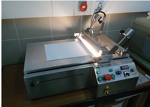
Figura 3.1 - Máquina de revestimento utilizada.
