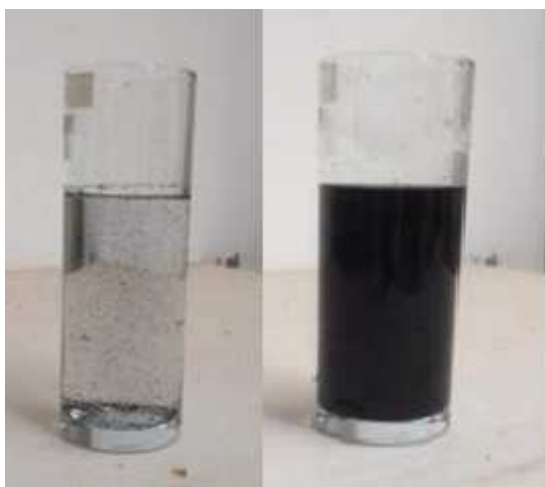
Figura 9 - Suspensão de MWCNTs antes da aplicação de ultrassons (a) e depois da aplicação de ultrassons (b).
