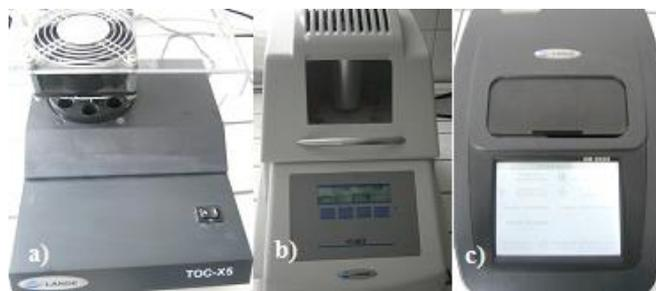
**Figura 5. 8-** (a) Agitador; (b) Termoreator; (c) Fotómetro;
