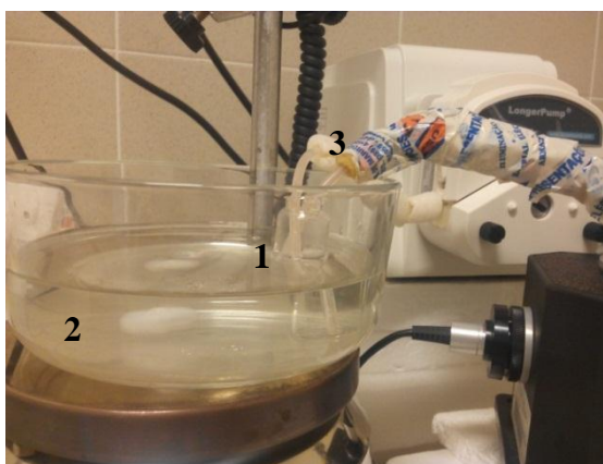
Figura 2.5. Imagens do arranjo experimental utilizado no ensaio da tripsina imobilizada. 1 – Vial contendo solução de substrato e membrana com enzima imobilizada, agitado magneticamente. 2 – Banho termoestático agitado magneticamente. 3 – Tubagem com isolamento térmico.
