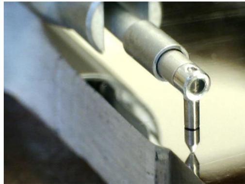
Figura 3.4. Medição de rugosidade de um provete C(T).
