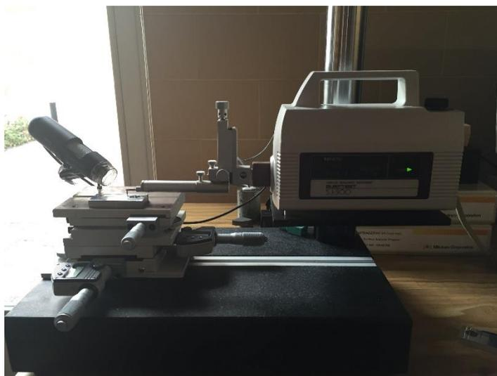
Figura 3.3. Rugosímetro utilizado nos ensaios
