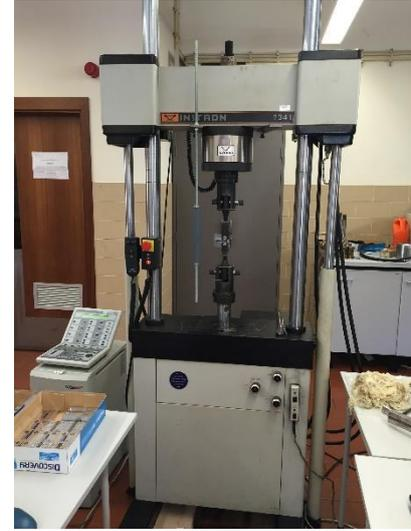
Figura 3.10. Máquina de fadiga uniaxial utilizada nos ensaios
