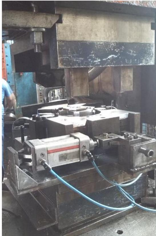
Imagem de ferramenta de conformar gola 124 instalada na PH17.
