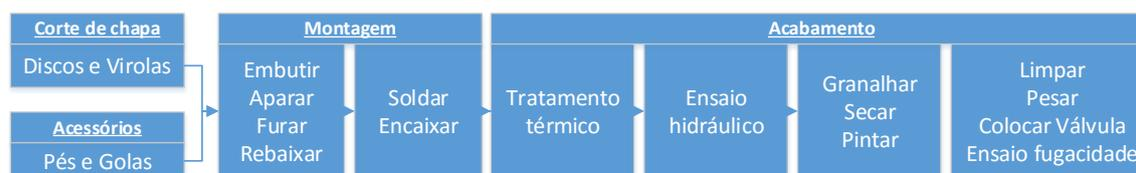
**Figura 1.4.** Processo para obtenção de uma garrafa convencional
