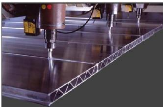
Figura 2.13. Painéis do A-Trains sendo soldados por FSW [11]
