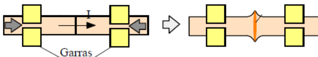
Figura 2.16. Esquemática gráfica da soldadura de topo por resistência (UW) [17].
