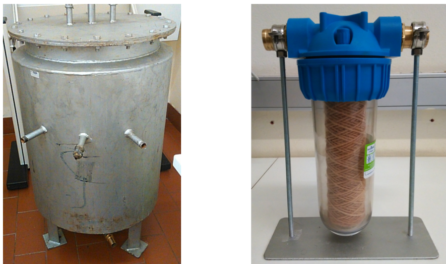
Figura 3.4: Reservatório de aproximadamente 200 litros de capacidade (esquerda) e Filtro Atlas SX Plus (direita).
