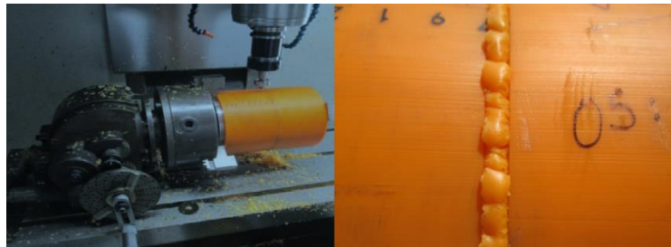
Figura 2.14 – Processo de soldadura e aparência externa da soldadura (Pinzón S., 2014).
