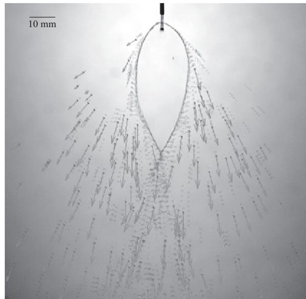
**Figura 1.3:** Espectro da folha de líquido obtido quando  $N_j = 2$  (Panão & Delgado, 2014).
