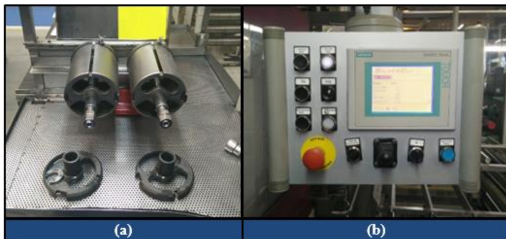
Figura 23 - (a) Camisas de corte (b) Controlador PLC
