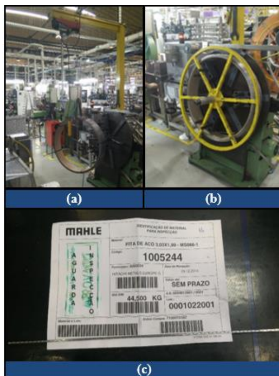
Figura 18 - (a) rolo de fita de aço (b) rolo condicionado no desbobinador (c) amostra de fita
