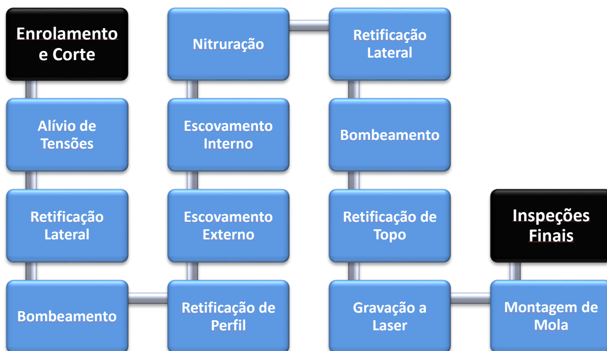
Figura 15 - Esquema do processo do Anel I-shaped
