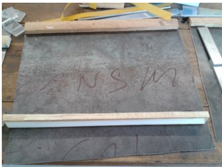
Figura 3.2. “Gabarits” utilizados para garantir o 20mm de comprimento de sobreposição entre aderentes.
