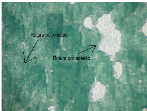
Figura 4.17. Rotura mista no provete sem “taper” (vista de microscópio).
