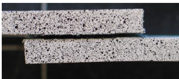
Figura 4.5. Rotura do provete sem “taper”.
