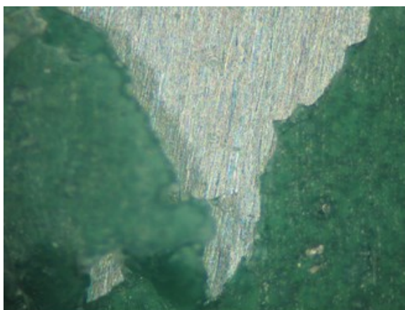
Figura 4.18. Rotura por adesão no provete com “taper” em adesivo com 45° (vista de microscópio).
