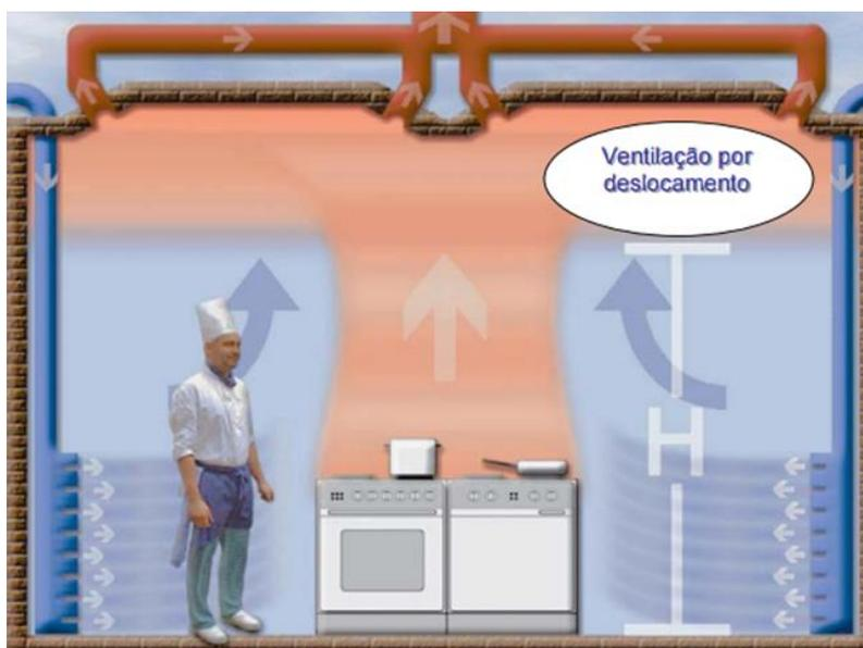
**Figura 3.36.** Esquema de funcionamento de ventilação por deslocamento (EU-OSHA, 2008).
