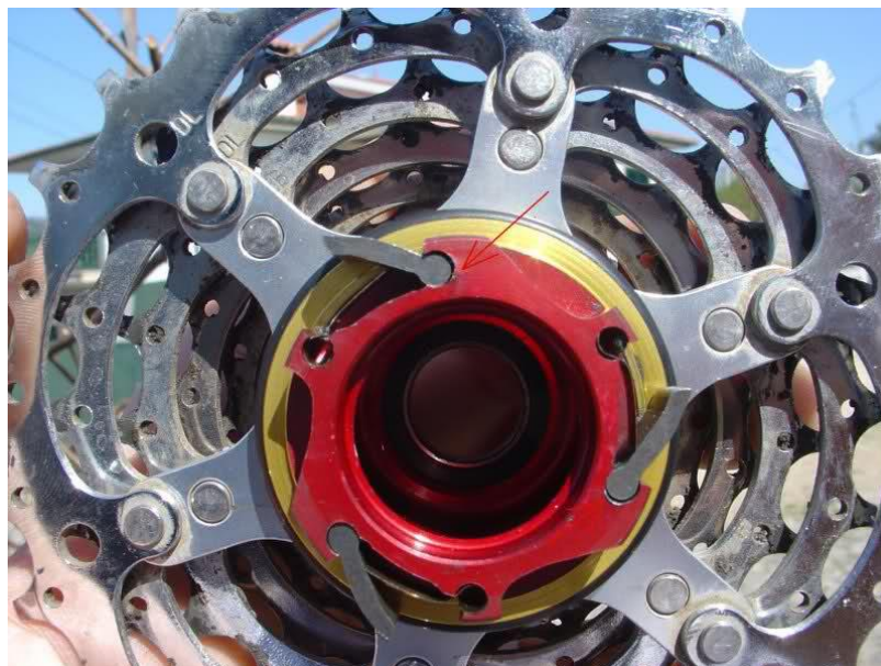
Figura 2.3. Sistema de linguetes (Shimano, 2014).
