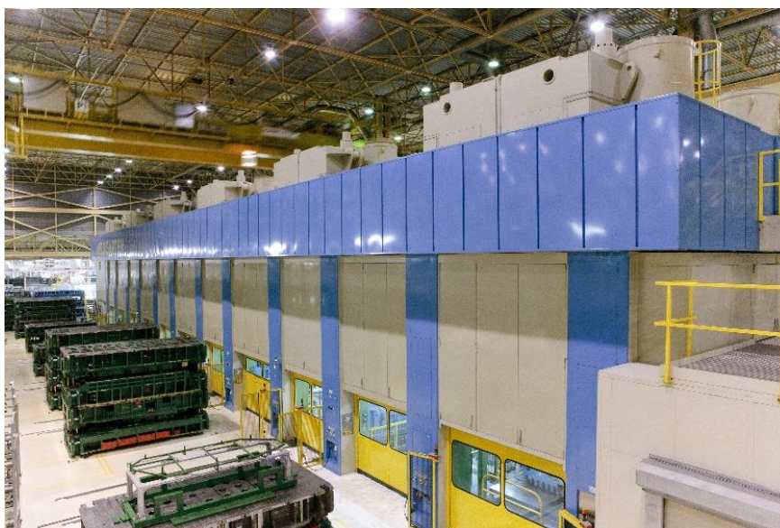
Figura 2-1 Prensa TANDEM com processo multi-etapa (cortesia Volkswagen AutoEuropa)
