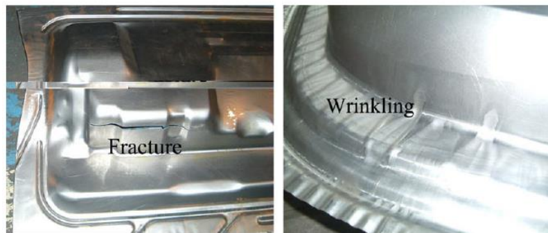
Figura 1-22 Exemplo de fissuração e de enrugamento numa embutadura (Sun et al., 2010)
