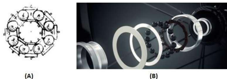
Figura 2.8. Modelo de rolamento desenvolvido por Leonardo da Vinci ( Santo Vito Rolamentos ) e vista explodida de um rolamento atual da ( Campagnolo ).
