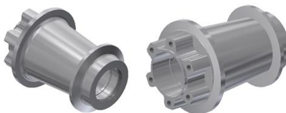
Figura 3.4. Novo cubo das rodas frontais.
