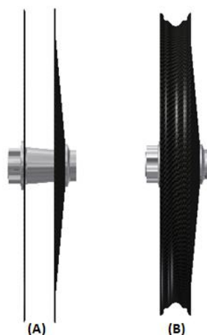
Figura 3.12. Novos tampões das rodas: Sem aro (A) e com aro (B).
