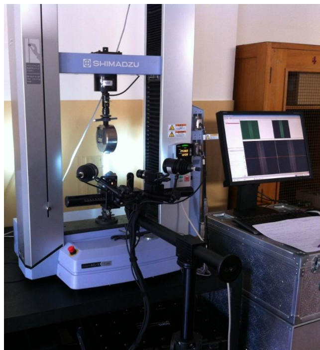
Figura 3.6 – Máquina de tração da Shimadzu e extensómetro ótico, modelo Aramis 5M, da Gom.
