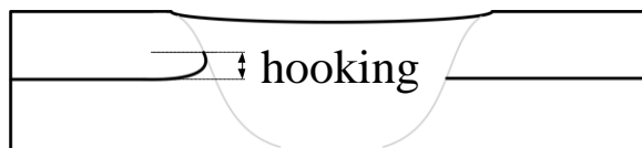
Figura 4.7 – Esquema de medição do defeito do tipo hooking .
