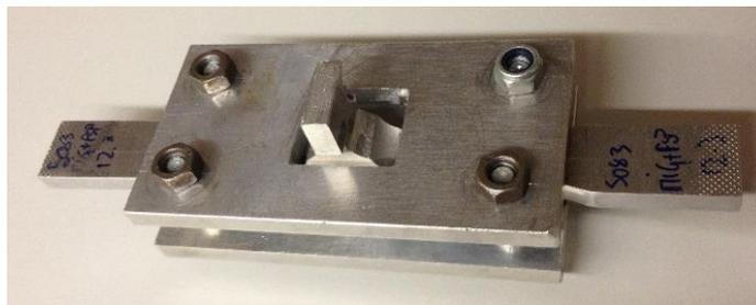
**Figura 3.8.** Dispositivo utilizado nos ensaios de tração para não ocorrer flambagem.
