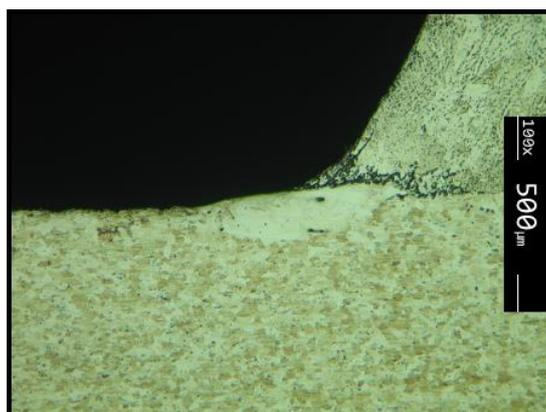
**Figura 2.5.** Falta de molhagem na soldadura MIG, visível pela pequena zona escura de transição entre o material fundido e o material base (resultado obtido no decorrer da presente tese).
