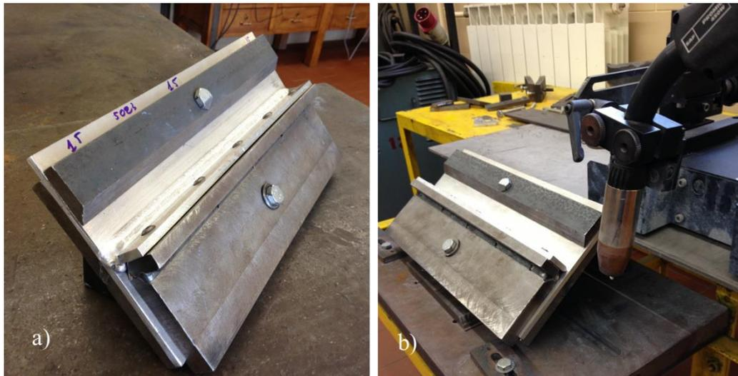
**Figura 3.2.** Imagem a) apresenta a placa fixada na base pronta para soldar e b) apresenta a base posicionada para o processo de soldadura.
