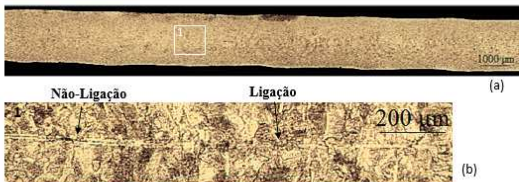
Figura 21 – Microestrutura da amostra 2: (a) secção longitudinal; (b) detalhe da zona 1.
