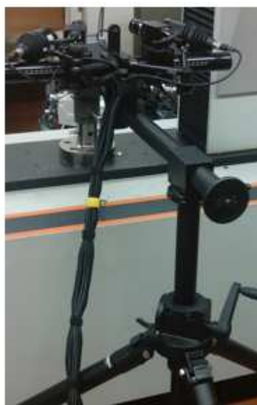
Figura 15 - Equipamentos dos Ensaio de Tração: (a) Máquina de Tração Instron Electropuls ; (b) Extensômetro Óptico Gom Aramis 5M .
