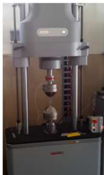
Figura 15 - Equipamentos dos Ensaio de Tração: (a) Máquina de Tração Instron Electropuls ; (b) Extensômetro Óptico Gom Aramis 5M .
