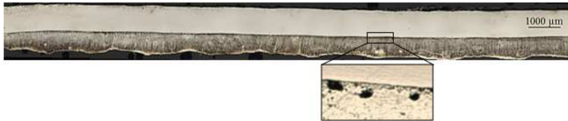
Figura 33 - Secção longitudinal da amostra 16 e detalhe da porosidade.
