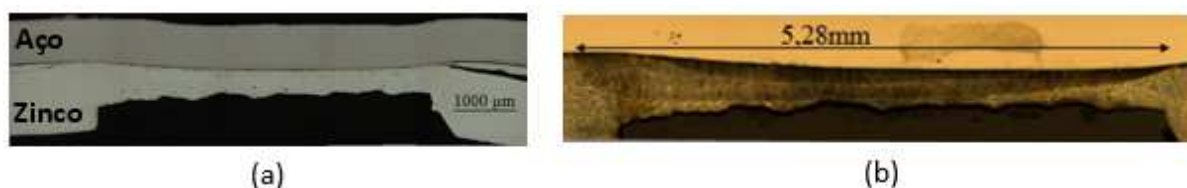
Figura 32 - Secção transversal da amostra 16: (a) antes de ataque químico; (b) após ataque químico.
