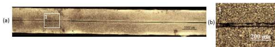
Figura 17 - Microestrutura da amostra 3: (a) secção longitudinal; (b) zinco na interface das chapas.
