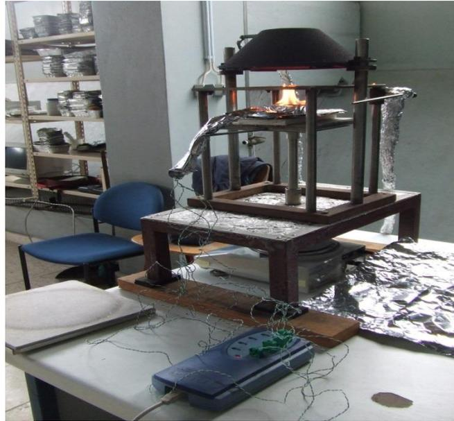
Figura 3.4 Sistema experimental – Calorímetro cónico
