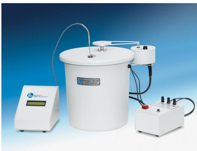
Figura 3.6 Sistema experimental - Calorímetro de bomba de oxigénio Parr 1341
