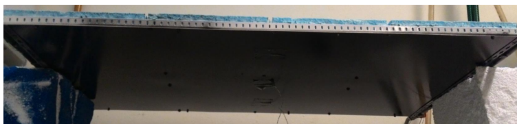
Figura 4.3: Revestimento aplicado à superfície radiante do Painel
