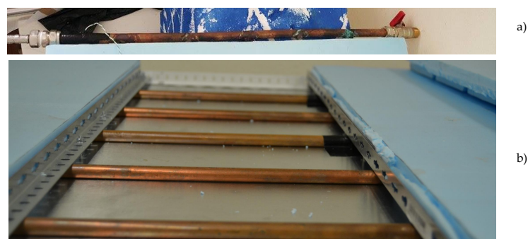
Figura 4.4: Vista detalhada do painel: a) Tubo coletor; b) Rede de tubos paralelos do Painel
