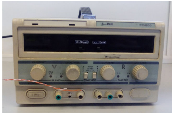
Figura 2.6. Fonte de alimentação para ignição dos filmes finos por aplicação de descarga elétrica.
