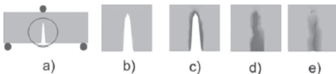
Figura 1.1. Princípio básico do self-healing : a) A carga mecânica induz a fissura; b) Vista detalhada da fissura; c) a fase móvel é induzida; d) a fissura é preenchida pela fase móvel; e) imobilização após reparação [2].
