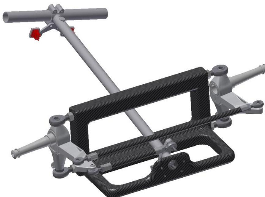
**Figura 46** Sistema de direcção montado.
