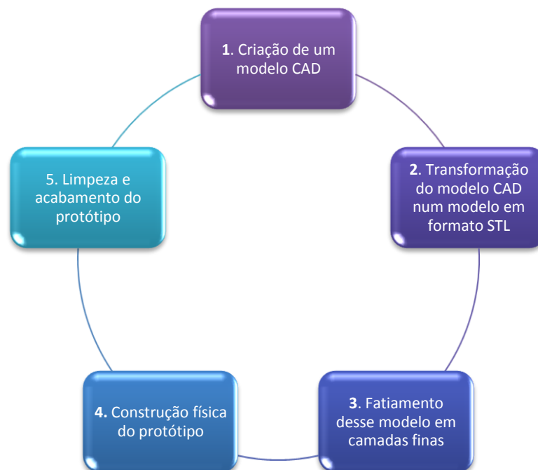
Figura 3. Princípio da prototipagem rápida.
