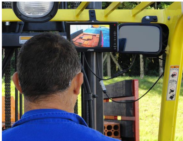
Figura 3.25. Sistema de ajuda visual ao operador no empilhador.
